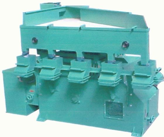
**Der Gewichtsausleser Typ KA wird zur Feinsortierung von Produkten mit gleicher Partikelgröße aber unterschiedlichem spezifischen Gewicht verwendet**
